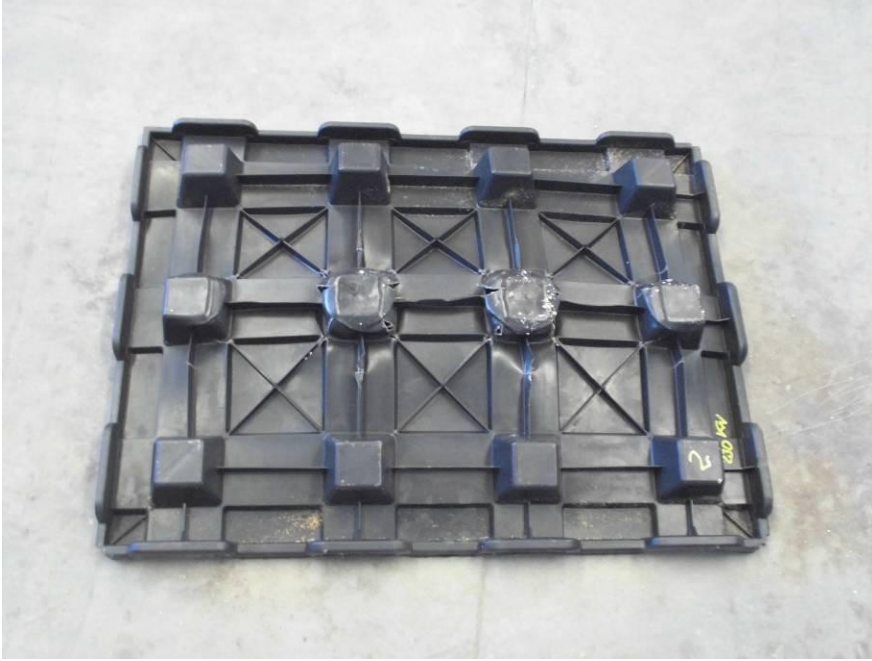
Resim 5: 0/12 kırma taş ile doldurulmuş 'DEFENDER' (sınırlanmış) numunesinin test sonunda kırılmış olan detayı (230 KN)
